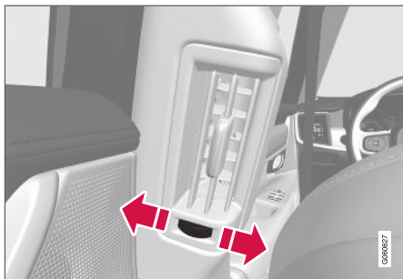
Stellrad der Belüftungsdüse 2 .
