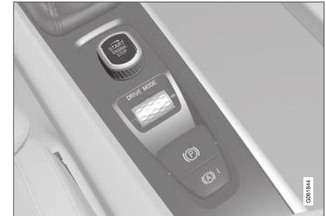
Startschalter auf der Tunnelkonsole.
