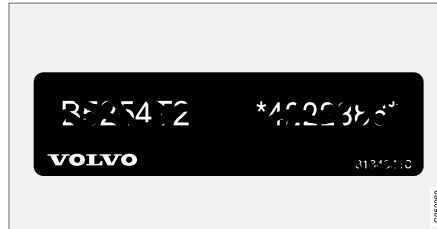
4 Tarra, jossa ovat moottorikoodi ja moottorin valmistusnumero.
