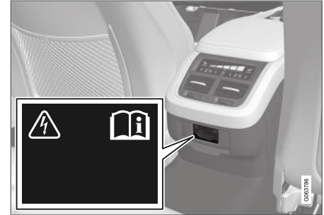
Sähköliitäntä tunnelikonsolissa, takaistuin.
