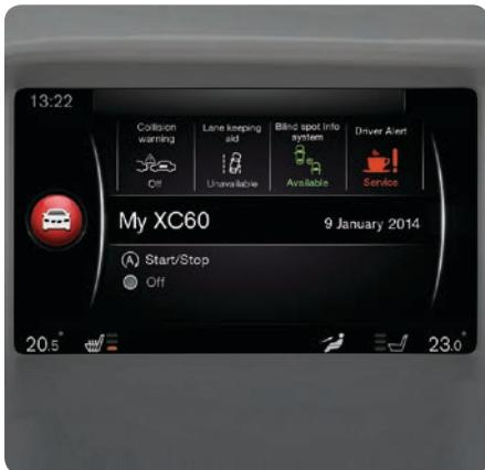
**MY CAR** では、時計、ドアミラーおよびロックの設定など、車両の多くの機能を設定します。
