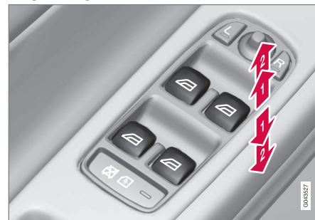
Regulering av vindusheiser.
