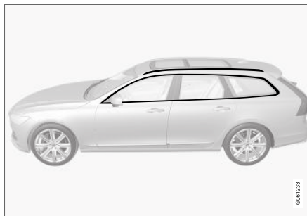
Μέρη που πρέπει να πλένονται με καθαριστικό με pH μεταξύ 3.5 και 11.5.
