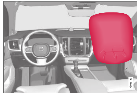
Αερόσακος στο κάθισμα του συνοδηγού.
