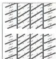
Slijtageprofiel zichtbaar, normale slijtage
