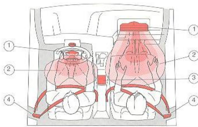
1. Gasgenerator 2. Opblaasbaar luchtkussen 3. Sensor 4. Gordelspanner
