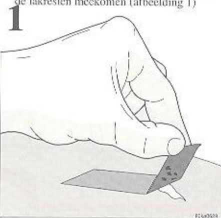
Lakresten met tape verwijderen
