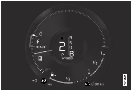
La pantalla del conductor indica carga al accionarse el freno motor eléctrico.
