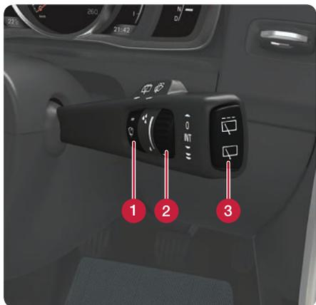
將撥桿向下移可啟動擋風玻璃雨刷，向上移可刷動一次。
