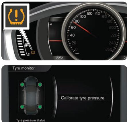
更換輪胎或改變胎壓後，務必進行校正。若燈光照明時 (⚠) 需要檢查胎壓並校正系統。依據下列步驟進行：
