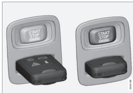
Contactsloot met transpondersleutel uitgetrokken/ingeduwd.
