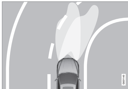
Fascio di luce con funzione disattivata (sinistra) o attivata (destra).
