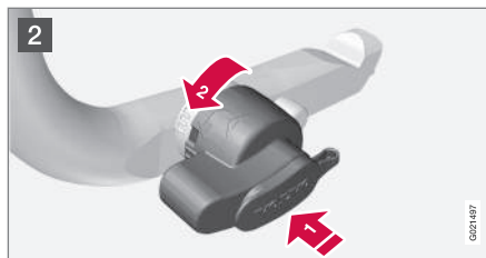
2 Premere la manopola di bloccaggio e ruotarla in senso antiorario finché non si sente un "clic".
