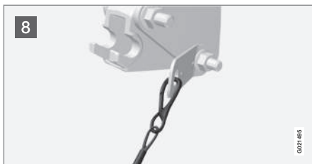
8 Cavo di sicurezza.
