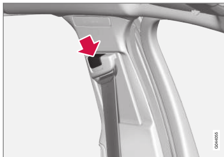
Ajuste vertical del cinturón de seguridad. Pulse el botón para desplazar el cinturón verticalmente. Coloque el cinturón lo más alto posible sin que roce con el cuello.
