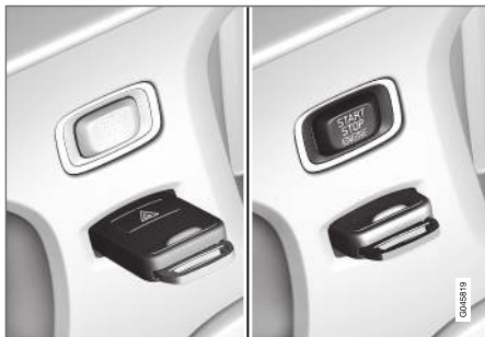
Cerradura de contacto con llave extraída o apretada y botón START/STOP ENGINE .
