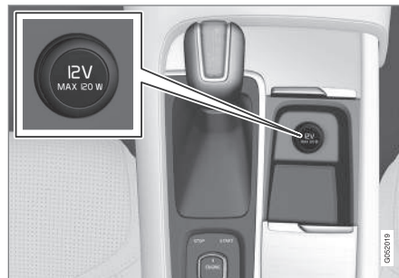
12 voltos elektromos aljzat az alagútkonzolban, első ülés.
