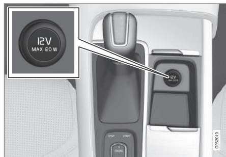
Tunnelkonsoolis olev 12 V elektrikupesa, esiiste.
