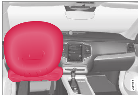
Airbag ve volantu a kolenní airbag na straně řidiče na předním sedadle.
