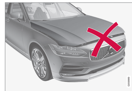
Capô não completamente fechado.
