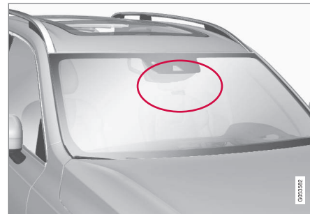
Localização da unidade do radar.
