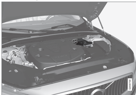
La batterie d'appoint 12 V est placée dans un caisson près de la tourelle d'amortisseur.
