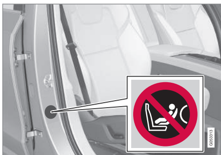
Інформаційна табличка на стійці дверцят з боку пасажирів. Інформаційна табличка подушки безпеки помітна, коли дверцята пасажирів відчинені.
