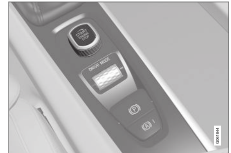
De startknop op de tunnelconsole.
