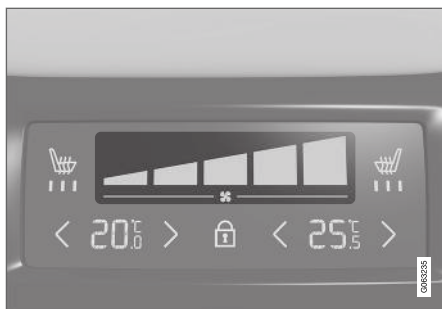
Ventilatorregeling op klimaatpaneel achter op tunnel-console.
