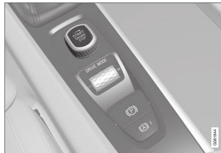
De startknop op de tunnelconsole.
