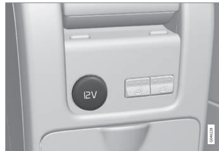
12 V stikkontakt i tunnelkonsollen, bagsædet.
