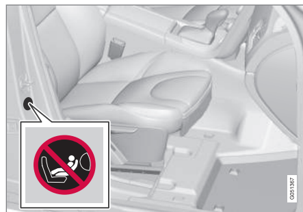
Mærkat på passagersidens dørstolpe. Mærkaten bliver synlig, når passagerdøren åbnes.
