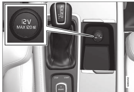
12V-aansluiting in tunnelconsole, voorin.
