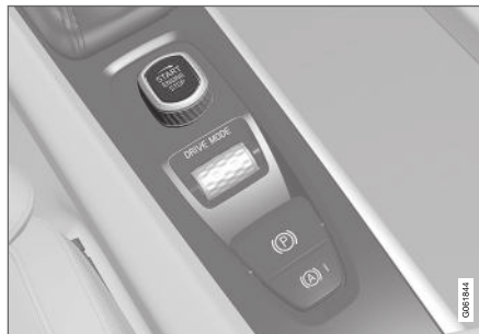
De startknop op de tunnelconsole.
