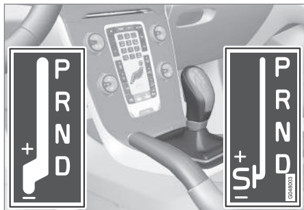
D: Posizioni del cambio automatico. +/-: Posizioni del cambio manuale. S: Modalità Sport*. 12
