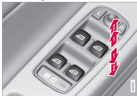
Manövrering av fönsterhissar.
