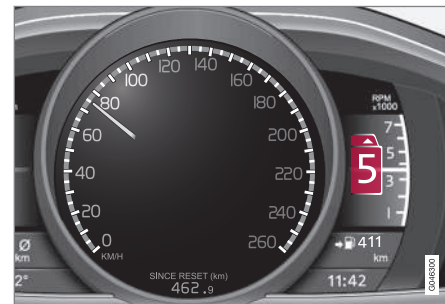
Kombiinstrument "Digital" med växlingsindikator.
