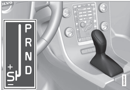
D: Automatiska växellägen. +S- : Manuella växellägen. S: Sportläge*.
