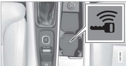
ตำแหน่งของตัวอ่านคีย์รอนในคอนโซลบริเวณโพงพกลาง
