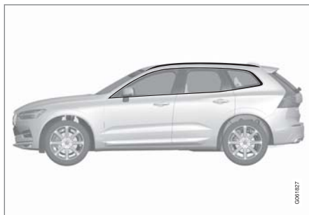
ชิ้นส่วนที่ควรล้างด้วยน้ำยาทำความสะอาดที่มีค่า pH ระหว่าง 3.5 ถึง 11.5
