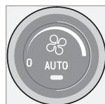
On peut régler la vitesse du ventilateur en actionnant le commutateur. La vitesse du ventilateur est réglée automatiquement lorsque **AUTO** est sélectionné. La vitesse du ventilateur antérieurement réglée est désactivée.
