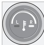
Les températures côté conducteur et côté passager peuvent être réglées séparément au moyen de la molette (identifiée par un symbole de thermomètre). La température peut être réglée pour les deux côtés du véhicule lorsque le contact est mis (les deux DEL sont alors allumées), ce qui signifie que tout réglage de la température vaudra pour les deux côtés du véhicule.
