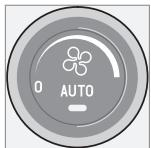
La fonction **AUTO** régule automatiquement la circulation d'air afin de maintenir la température désirée. La fonction automatique règle le chauffage, la circulation d'air, la vitesse du ventilateur, la recirculation et la distribution de l'air. Si vous sélectionnez une ou plusieurs fonctions, les fonctions restantes continuent d'être réglées automatiquement. Tous les réglages manuels sont désactivés lorsque **AUTO** est mis en marche. Le message
