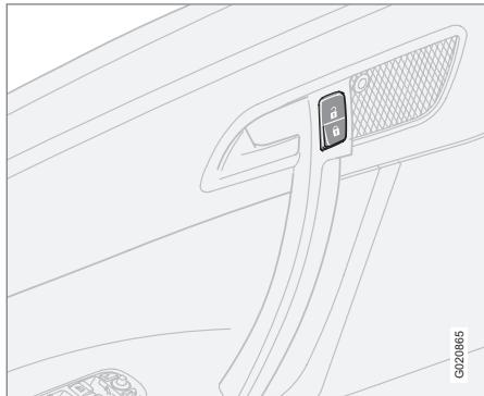
Les commutateurs près des poignées sur l'une ou l'autre des portières peuvent être utilisés pour verrouiller ou déverrouiller les deux portières et le coffre et pour régler l'alarme.
