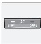
**ON** : Le système de climatisation est activé lorsque le témoin **ON** est allumé et il est commandé automatiquement pour maintenir la température sélectionnée.
