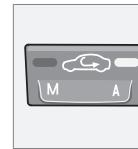
Ce système comprend un filtre multiple qui permet de réduire les gaz et les particules dans l'air entrant et un capteur de mesure de la qualité de l'air qui détecte les niveaux accrus de contaminants dans l'air extérieur. Lorsque le capteur de mesure de la qualité de l'air détecte que l'air extérieur est contaminé, l'entrée d'air se ferme et l'air à l'intérieur de l'habitacle est recirculé. Le filtre nettoie aussi l'air recyclé de l'habitacle.
