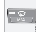
Pointe le débit d'air sur le pare-brise et les vitres latérales et augmente la vitesse du ventilateur. Lorsque le dégivreur est en marche :
