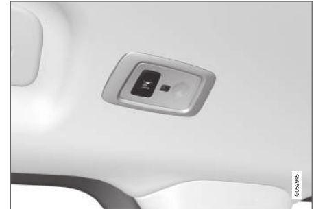
Panorama tavanı* olan araçlarda tavanın her iki tarafında birer tane olmak üzere iki lamba ünitesi vardır.
