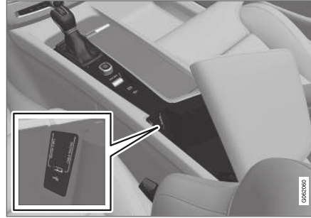
Tünel konsolundaki USB girişleri (tip A). Kapak kapalıyken sıkışmayacağı şekilde kabloyu ileri doğru döşeyin.
