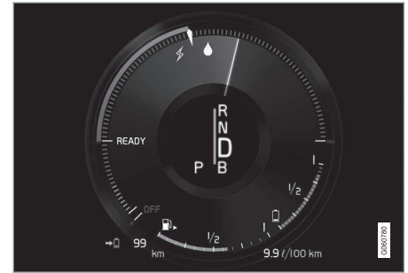
Sähkömoottori ei voi tuottaa pyydettyä moottorin tehoa ja polttomoottori käynnistyy.
