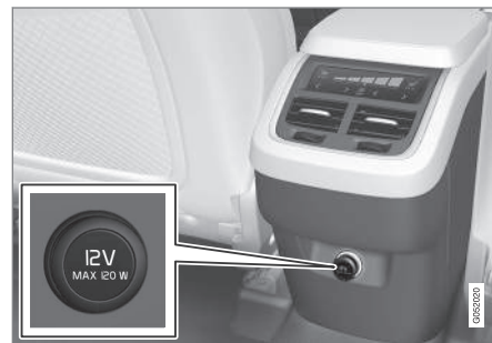
12 V:n sähköliitäntä tunnelikonsolissa, toinen istuinrivi.
