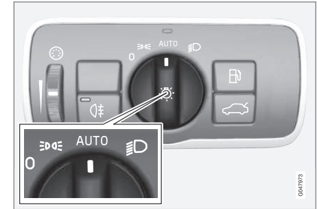
Drehregler des Lichtschalters in Stellung AUTO .
