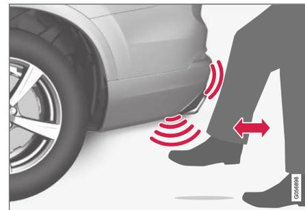
Lancement du pied dans la zone d'activation du capteur.
