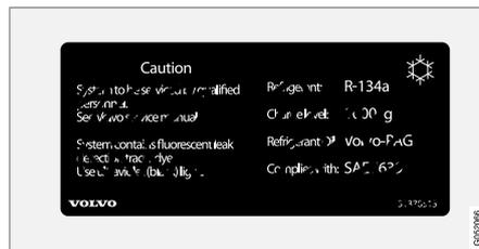
**6** **Autocollant de climatisation** fluide frigorigène R134a.
