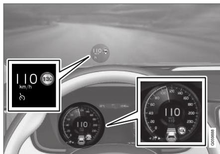
L'illustration précédente<sup>55</sup> montre que le régulateur de vitesse adaptatif est réglé pour maintenir une vitesse de 110 km/h (68 mph) et qu'il n'existe pas de véhicule cible à l'avant à suivre.
