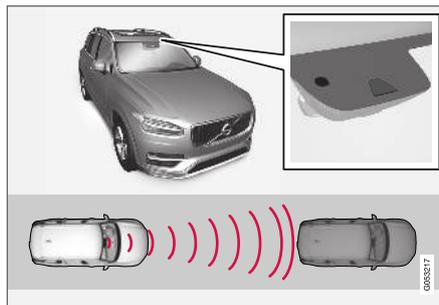
La caméra/le capteur radar mesurent la distance par rapport au véhicule qui précède<sup>38</sup>.
