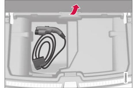
Le câble de chargement est rangé dans un compartiment de rangement sous le plancher du compartiment de chargement.
