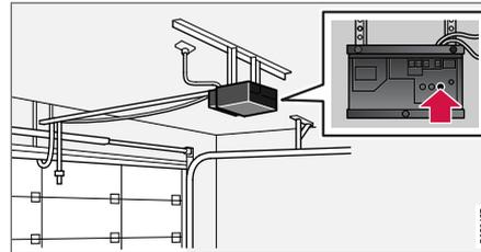
4. Localiser le bouton de formation<sup>13</sup> sur le récepteur pour par exemple l'ouvre-porte de garage. Il se trouve habituellement près du support d'antenne sur le récepteur.
