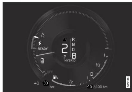
Le véhicule génère du courant électrique pour charger la batterie, par exemple lorsque le conducteur appuie légèrement sur la pédale de frein ou lorsque le frein moteur est utilisé en descente.
