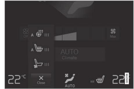
Volant et boutons de siège dans la barre de climatisation.
