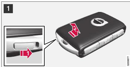
1 **1** Tenir la clé de commande à distance avec le côté avant (avec le logo Volvo) dirigé vers le haut et déplacer le bouton de la section de bague de clé vers la droite. Faites glisser le couvercle avant légèrement vers le haut.
