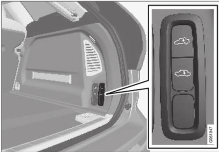
Utiliser les boutons du compartiment à bagages pour lever ou abaisser la section arrière du véhicule et faciliter le chargement ou le déchargement du véhicule, la connexion ou la déconnexion d'une remorque.
