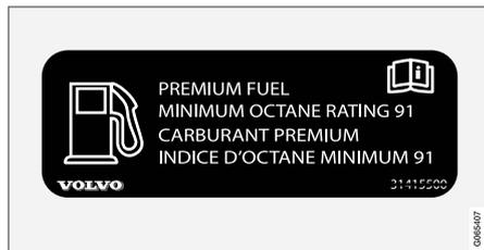
Illustration 2 : autocollant à l'intérieur de la trappe à remplissage de carburant sur les véhicules qui exigent du carburant de première qualité<sup>7</sup>.
