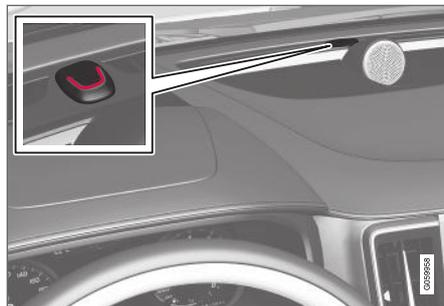
Le témoin de verrouillage et d'alarme de la planche de bord affiche l'état du système de verrouillage.
