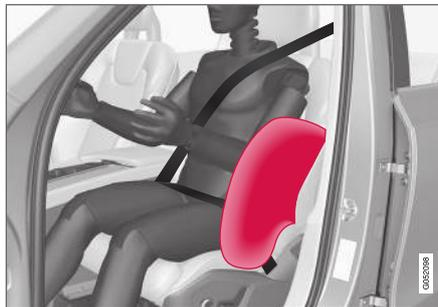
Les coussins gonflables latéraux sont montés dans les encadrements extérieurs des dossiers des sièges avant et contribuent à protéger le conducteur et le passager avant.
