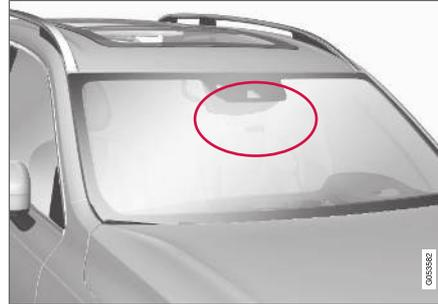
La zone marquée dans l'illustration doit être exempte d'autocollants, d'objets, de film solaire, etc.<sup>68</sup>
