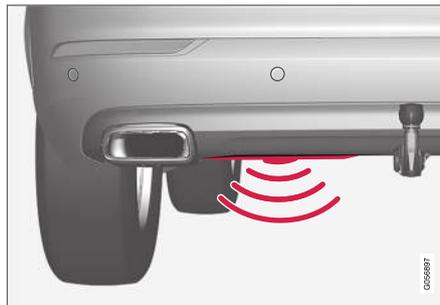
Le capteur se trouve à gauche du centre, sous le pare-chocs arrière<sup>18</sup>.
