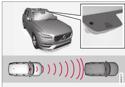
Emplacement de la caméra et du capteur radar<sup>69</sup>.
