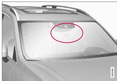
La zone marquée dans l'illustration doit être exempte d'autocollants, d'objets, de film solaire, etc.<sup>64</sup>
