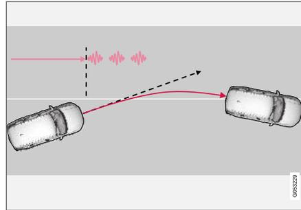
L'aide au maintien sur la voie alerte le véhicule en utilisant des vibrations dans le volant de direction<sup>104</sup>.
