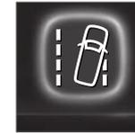
Ce pictogramme sur le tableau de bord indique que la LKA est activée et vérifie en permanence que le conducteur a les mains sur le volant.
