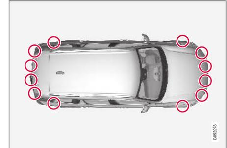
Emplacement des capteurs d'aide au stationnement<sup>112</sup>.
