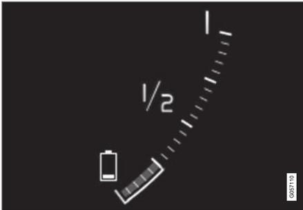
1. Si le niveau de charge de la batterie hybride est élevé, conduire le véhicule jusqu'à ce que le niveau de charge soit d'environ 25 %. Si le niveau de charge est bas, charger la batterie jusqu'à ce que le niveau atteigne environ 25 %.
