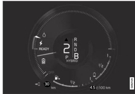
Le véhicule génère du courant pour recharger la batterie, par exemple pendant un freinage léger ou un freinage moteur en descente.
