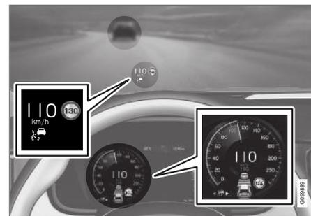
L'illustration précédente<sup>55</sup> montre que le régulateur de vitesse adaptatif est réglé pour maintenir une vitesse de 110 km/h (68 mph) et qu'il suit un véhicule cible à l'avant qui roule à la même vitesse.
