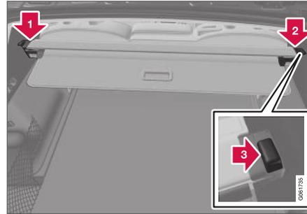
1. Insérez l'un des embouts du cache-bagages dans l'évidement du panneau latéral de compartiment à bagages.
