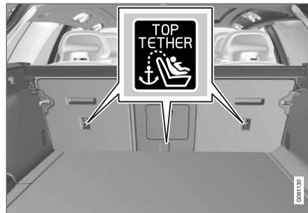
Ancrages d'attache supérieurs et symboles sur la face arrière des dossiers de sièges arrière. Il n'existe aucun symbole pour les ancres d'attache centraux.
