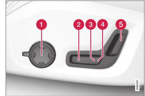
L'illustration montre les commandes d'une voiture équipée du soutien lombaire à quatre directions\*. Les voitures équipées d'un soutien lombaire à quatre directions\* ne disposent pas de la commande multifonction rotative.
