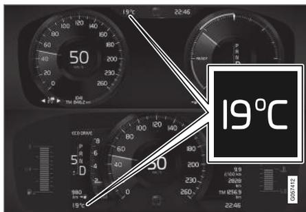
Emplacement du capteur de température ambiante dans le tableau de bord de 12 pouces et de 8 pouces
