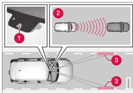
Le capteur de caméra/radar surveille la distance par rapport au véhicule qui précède et détecte les marquages de voie<sup>56</sup>.
