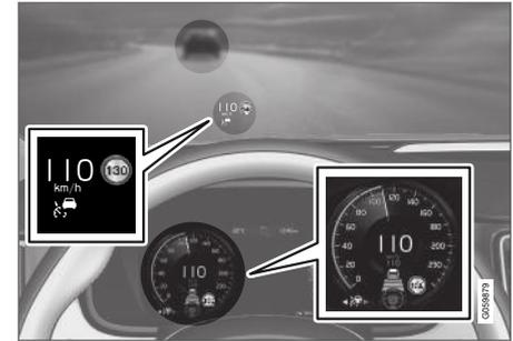
L'illustration précédente<sup>63</sup> montre que Pilot Assist est réglée pour maintenir une vitesse de 110 km/h (68 mph) et suit un véhicule cible à l'avant, qui circule à la même vitesse.
