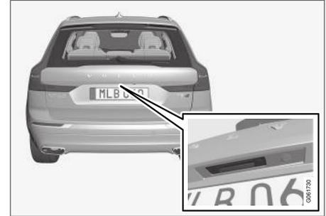
La plaque de pression caoutchoutée du hayon est utilisée uniquement pour le déverrouillage.
