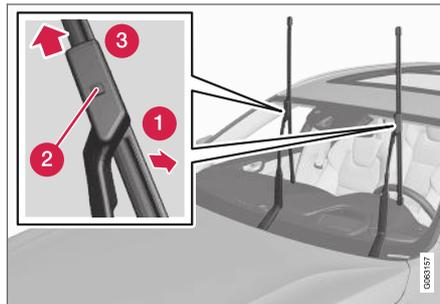
1. Lever les bras d'essuie-glace en position d'entretien. La position d'entretien est activée/désactivée via la vue de fonction dans l'affichage central lorsque la voiture est arrêtée et que l'essuie-glace du pare-brise ne fonctionne pas.
