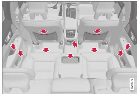
Compartiment de rangement dans le panneau de porte, les porte-gobelets\* dans le dossier de siège central, pochette de rangement\* dans le dossier de siège avant, prises électriques dans la console centrale et compartiment de rangement sous le siège.
