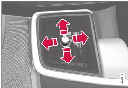
Commande de flux d'air<sup>2</sup>.
