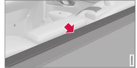
Le rabat avant doit être dirigé vers le bas, derrière le dossier, avant la mise en place de la cassette.
