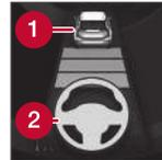
L'assistance de direction du système Pilot Assist est uniquement active quand le symbole du volant (2) passe du GRIS au VERT.
