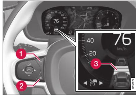
Commandes de paramétrage d'un intervalle de temps<sup>44</sup>.
