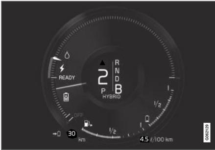
Lorsque la batterie est chargée au moyen de la fonction de freinage du moteur électrique, ceci est indiqué au tableau de bord.
