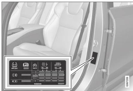
L'autocollant spécifie la désignation des pneus montés en usine sur le véhicule, ainsi que les limites de charge et les pressions de gonflage.
