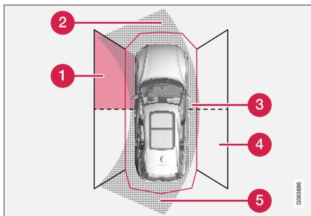
Secteurs des capteurs d'aide au stationnement où les obstacles peuvent être détectés<sup>119</sup>.
