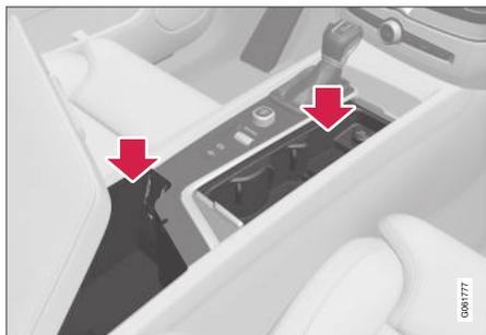
Compartiments de rangement avec porte-gobelet, prises électriques et prises USB dans la console de tunnel
