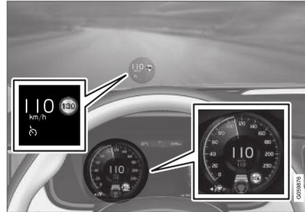
L'illustration précédente<sup>63</sup> montre que Pilot Assist est réglée pour maintenir une vitesse de 110 km/h (68 mph) et qu'il n'existe pas de véhicule-cible à l'avant à suivre.
