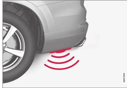
Pour activer l'ouverture et la fermeture par un mouvement du pied sur un véhicule avec plaque de protection, exécuter un mouvement de coup de pied sur le côté du véhicule. Une des télécommandes du véhicule doit se trouver dans la portée (environ 1 mètre (3 pieds)) pour que l'ouverture et la fermeture soient possibles.
