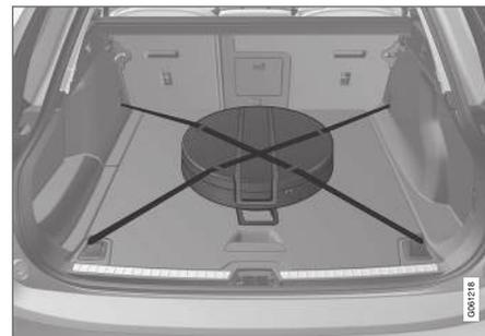
La roue de secours est rangée dans un sac et doit être assujettie avec deux sangles sur le plancher du coffre/compartiment à bagages pendant les trajets. Les sangles doivent être croisées par-dessus la roue, fixées aux œillets d'ancrage de charge et tendues.
