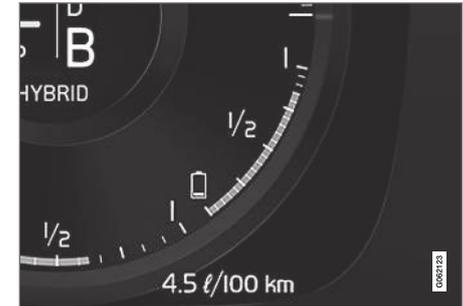
Le courant de la batterie hybride est utilisé pour alimenter le moteur électrique mais peut également servir à réchauffer ou à refroidir le véhicule. L'ordinateur de bord calcule une distance de conduite approximative avec le courant restant dans la batterie hybride.
