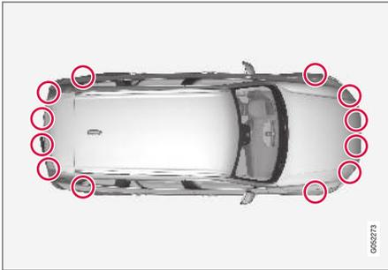
Emplacement des capteurs d'aide au stationnement<sup>127</sup>.
