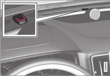
Une diode rouge de la planche de bord clignote toutes les secondes lorsque le véhicule est verrouillé et que l'alarme est armée.
