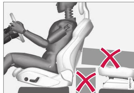
Ne placer aucun objet sur le sol derrière ou sous les sièges avant ni sur le siège arrière qui risque d'empêcher le fonctionnement de WHIPS.
