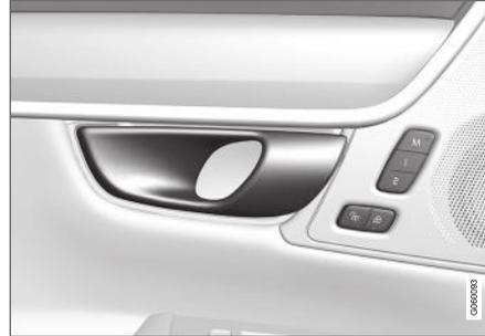
Méthode alternative de déverrouillage en utilisant la poignée d'ouverture de porte latérale<sup>15</sup>.
