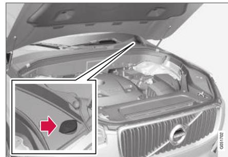
Le liquide lave-glace est versé dans le réservoir dont le bouchon est bleu. Le réservoir est utilisé pour le lave-glace de pare-brise, le lave-glace de vitre du hayon et le lave-phare\*
