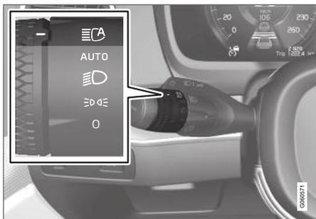
Les feux de route actifs sont activés en déplaçant la bague d'éclairage du levier du volant de direction vers **AUTO**.
