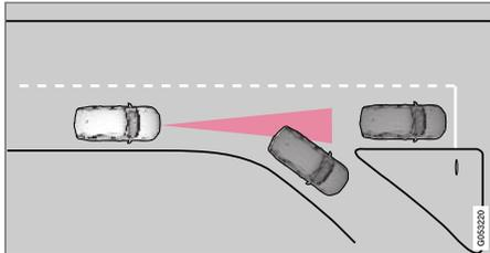
Si le véhicule cible à l'avant tourne brusquement, il peut exister une circulation arrêtée à l'avant.
