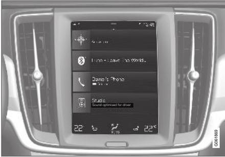
De nombreuses fonctions principales du véhicule sont commandées depuis l'affichage central, un écran tactile qui réagit aux effleurements et autres gestes. Ceci minimise le nombre de boutons et commandes physiques nécessaires dans le véhicule. L'écran peut également être utilisé en portant des gants.
