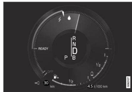
L'indicateur du tableau de bord s'allume lorsque le moteur électrique et le moteur à thermique sont utilisés.
