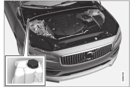
Vase d'expansion de liquide de refroidissement, véhicule avec direction à gauche.
