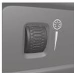
La molette de la planche de bord à gauche du volant de direction peut être utilisée pour régler l'intensité lumineuse de l'affichage, de l'instrumentation, de l'éclairage ambiant et de l'éclairage d'atmosphère\*.
