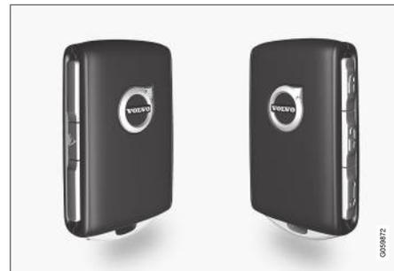
La clé à télécommande possède quatre boutons : un bouton sur le côté gauche et trois boutons sur le côté droit<sup>5</sup>.
