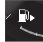
Une flèche à côté du pictogramme de pompe à carburant du tableau de bord indique le côté du véhicule sur lequel se trouve le volet du réservoir de carburant.
