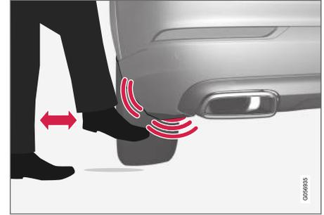
Lancement du pied dans la zone d'activation du capteur.
