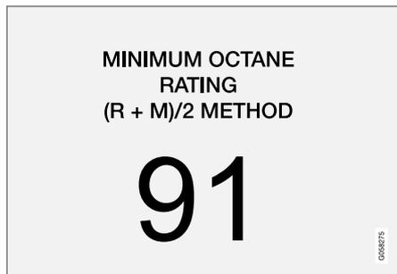
Illustration 1 : exemple d'étiquette d'indice d'octane<sup>6</sup> sur une pompe à carburant.
