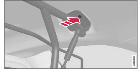
Visser la vis prévue en place en utilisant la clé Allen prévue de 6 mm. Répéter l'opération de l'autre côté. Couple recommandé : 20 Nm (15 lb-pi)
