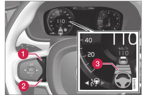
Commandes de paramétrage d'un intervalle de temps<sup>59</sup>.
