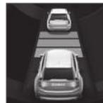
ACC régule uniquement l'intervalle de temps par rapport au véhicule qui précède lorsque le pictogramme de distance affiche deux véhicules.
