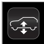
Le tableau de bord indique le moment où le niveau de la suspension pneumatique est en cours de réglage.
