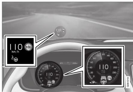
L'illustration précédente<sup>63</sup> montre que Pilot Assist est réglé pour maintenir une vitesse de 110 km/h (68 mph) et qu'il n'existe pas de véhicule-cible à l'avant à suivre.
