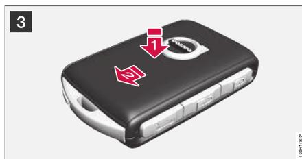
3 Replacer la lame de clé dans son emplacement prévu de la clé-télécommande après l'usage.
