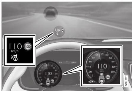
L'illustration précédente<sup>63</sup> montre que Pilot Assist est réglée pour maintenir une vitesse de 110 km/h (68 mph) et suit un véhicule cible à l'avant, qui circule à la même vitesse.
