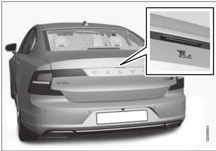
Pogumovaná přítlačná plocha na víku zavazadlového prostoru používaná pouze k odemykání.
