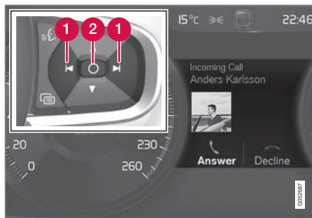
ドライバーディスプレイ のメッセージとステアリングホイール右側のステアリングリモコン
