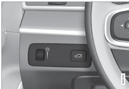
インテリアの明るさ調節用コントロールダイヤル (左側)
