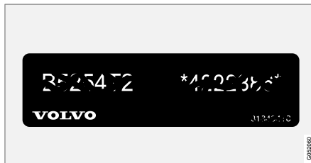
4 Tarra, jossa ovat moottorikoodi ja moottorin valmistusnumero.
