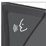
ステアリングホイールのボタンを押し、信号を待ってから、「Drive 自宅」(走行)などのように発声してください。
