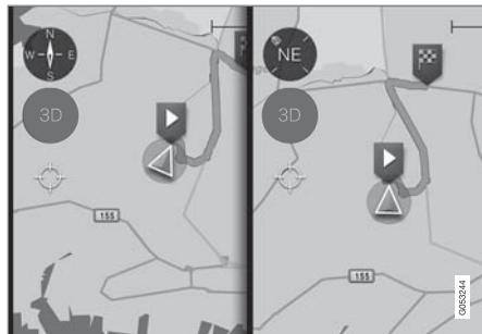
地図上で車両シンボルの動きを切り替えるには、コンパスをタップします。
