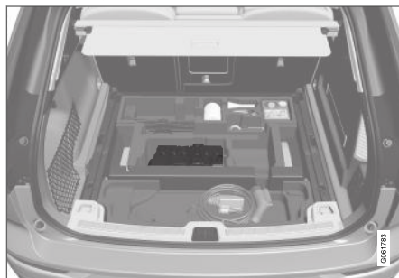
Startbatteriet sitter i bagasjerommet.
