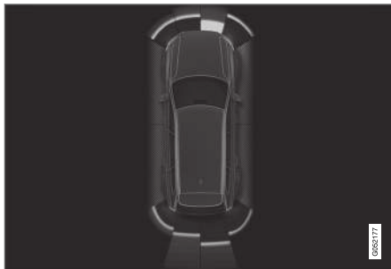
Bildeskjermvindu med hindringssoner og sensordetektorer.
