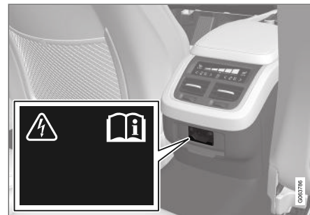
Strømuttak i tunnelkonsollen i baksetet.
