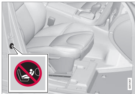
Placa en el montante de la puerta en el lado del acompañante. La placa se ve al abrir la puerta del acompañante.
