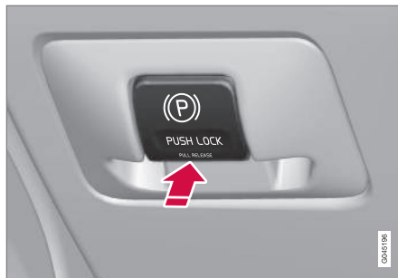
Mando del freno de estacionamiento - aplicación.
