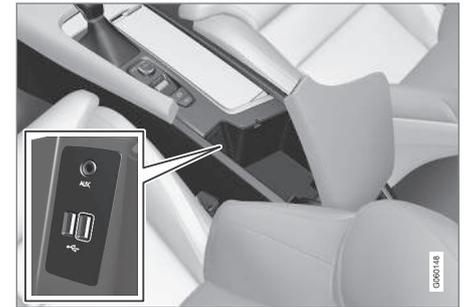
Tomada USB na consola de túnel.
