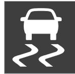
Quando o estabilizador de veículo com reboque actua, o símbolo **ESC** pisca no mostrador do condutor.
