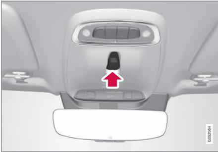
O tecto de abrir e a cortina são acionados com um comando que se encontra no tecto. O comando é ativado quando o sistema elétrico do automóvel está na posição de ignição I ou II.
