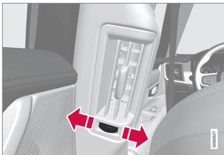
Selector rotativo da boca de ventilação<sup>4</sup>.
