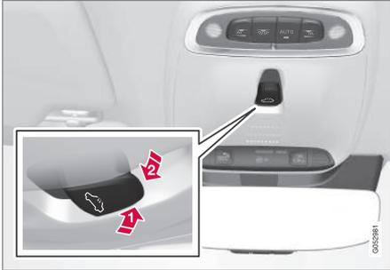
Posição de ventilação, vertical na margem traseira.
