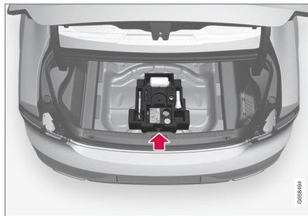
Sob o bloco de espuma no chão da carga encontra-se o olhal de reboque, o kit de reparação de emergência de pneus furados, a ferramenta para remoção das tampas de plástico dos parafusos das rodas e a manga dos parafusos das rodas bloqueantes.
