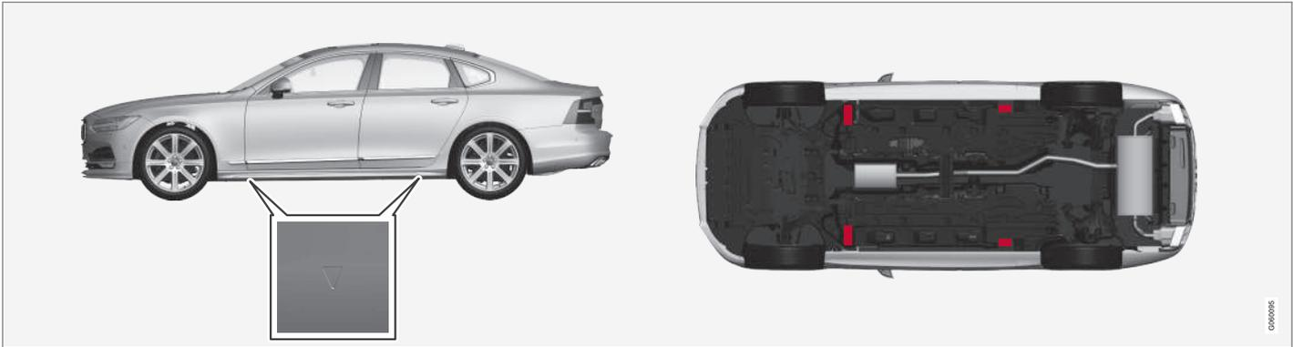
Os triângulos na cobertura de plástico apontam para as fixações do macaco/pontos de elevação (assinalados a vermelho).
