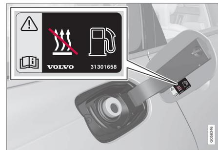
Autocolante no interior da tampa do depósito de combustível.
