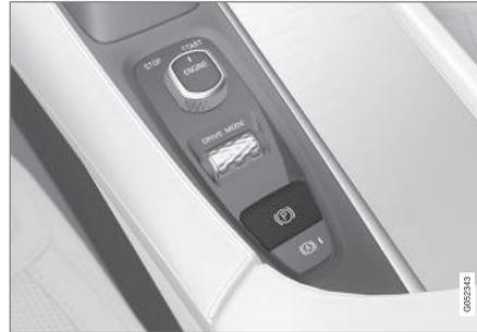
O comando do travão de estacionamento encontra-se na consola de túnel entre os bancos.
