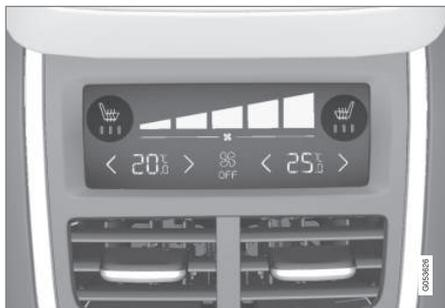
Indicação de aquecimento do banco e comando no painel de climatização traseiro na consola de túnel.
