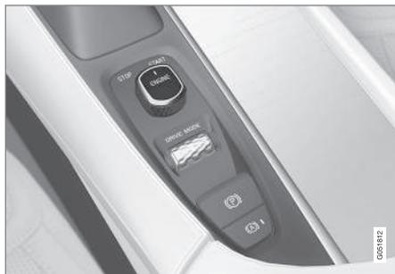
Disco de arranque na consola de túnel.
