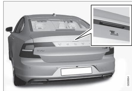
Placa de borracha com superfície sensível à pressão.
