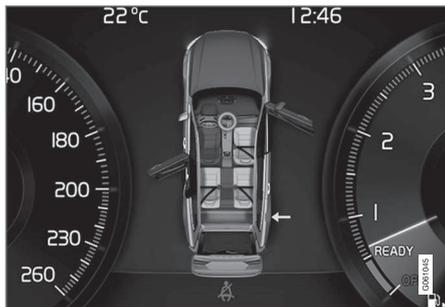
Gráfico no mostrador do condutor com diferentes tipos de avisos. A cor de aviso das portas e do porta-bagagens depende da velocidade do automóvel.
