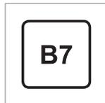
B7 é **Diesel** com o máximo de 7 vol % éster metílico de ácido gordo (FAME).
