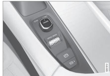
Disco de arranque na consola de túnel.
