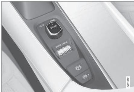
Disco de arranque na consola de túnel.
