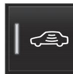
Pressione no botão **Protecção reduzida** na vista de função do mostrador central para desligar temporariamente os sensores de movimento e de inclinação.
