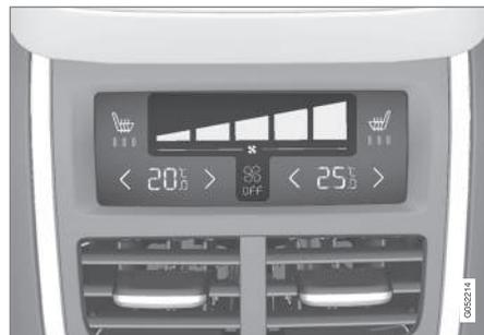
Comando do ventilador no painel de climatização traseiro na consola de túnel.
