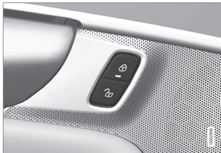
Pulsante di bloccaggio/sbloccaggio nella portiera anteriore con spia.
