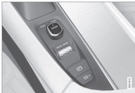
Interruttore di avviamento nel tunnel.
