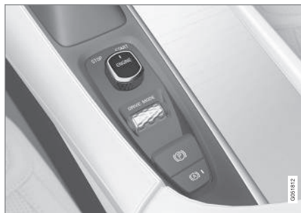
Interruttore di avviamento nel tunnel.
