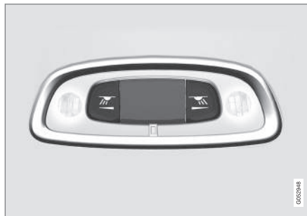
Luci di lettura sopra la seconda 13 e la terza fila di sedili*.
