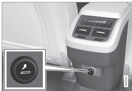
Accendisigari nel tunnel, seconda fila di sedili.
