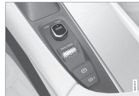
Interruttore di avviamento nel tunnel.
