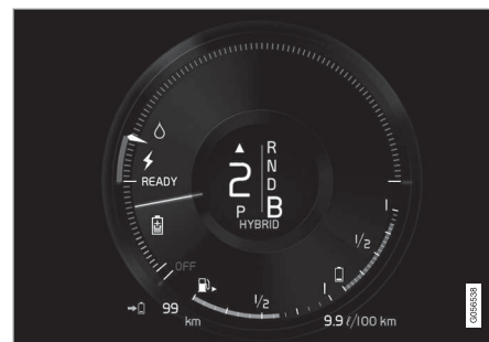
Il display del conducente indica la ricarica con il freno motore.
