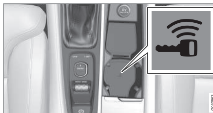
Posizione del lettore di riserva nel tunnel.
