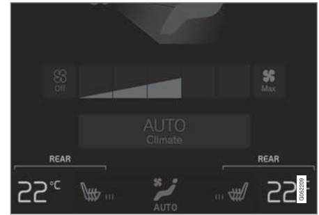
ปุ่มอุณหภูมิในแท็บ Rear climate ในมุมมองสภาพอากาศ
