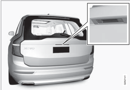
ประตูท้ายปิดค้างอยู่โดยล็อคไฟฟ้า
