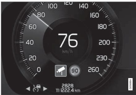
ข้อมูลกล้องตรวจจับความเร็วบนจอแสดงผลสำหรับคนขับ
