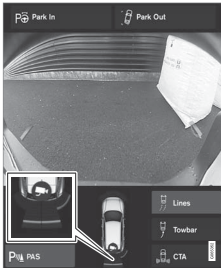
หน้าจอสามารถแสดงพื้นที่ของเซ็นเซอร์แบบเป็นสีบนสัญลักษณ์รถยนต์ได้
