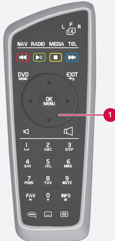
① Scrollrad, entspricht **TUNE** in der Mittelkonsole.
