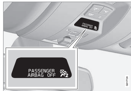
Az utaslégszák kiiktatott állapotát mutató visszajelző.
