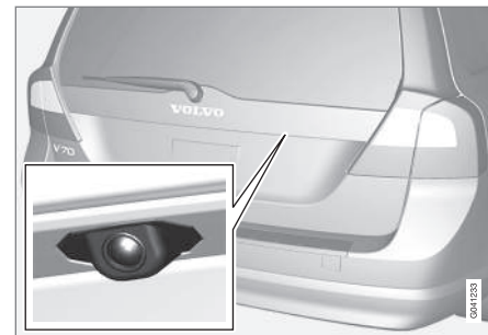
A kamera elhelyezkedése a nyitófogantyú mellett.
