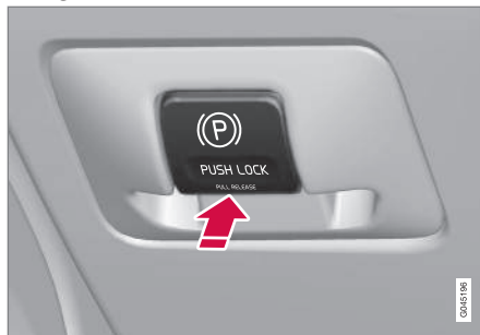
A rögzítőfék kezelőszerve - behúzás.
