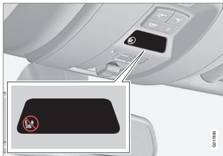
Az utaslégszák aktivált állapotát mutató visszajelző.
