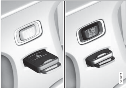
リモートコントロールキーを抜いた/差し込んだ状態のイグニッションスイッチ
