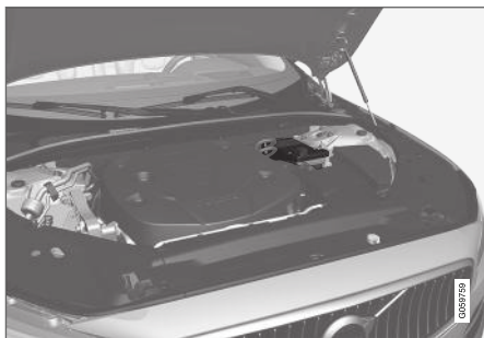
Pagalbinis akumulatorius yra dėžėje šalia statramsčio bokštelio.
