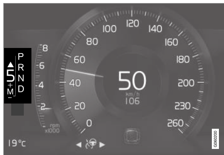
Pavarų perjungimo indikatorius 8 colių vairuotojo ekrane.
