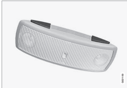
Потолочное освещение сзади.
