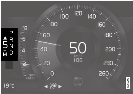
Témoin de rapport de vitesse dans le tableau de bord de 8 po.
