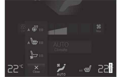
Volant et boutons de siège dans la barre de climatisation.
