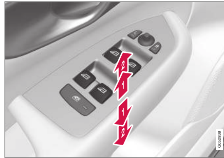
Fonctionnement des vitres électriques.
