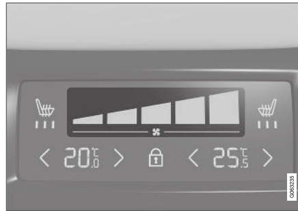
Commandes de soufflante sur le panneau de climatisation arrière de la console de tunnel.
