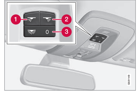
Ön okuma lambaları ve yolcu bölmesi aydınlatmasının tavan konsolundaki kumandaları.
