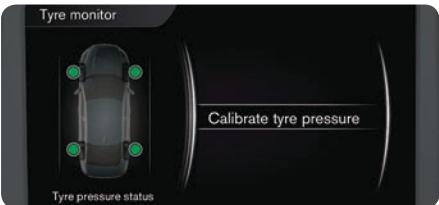
タイヤ交換後またはタイヤ空気圧の変更後には、必ず校正が必要です。④ランプが点灯した場合、タイヤ空気圧の点検とシステムの校正が必要です。以下の手順に従ってください。
