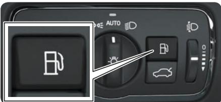
ライティングパネルのボタンを押して、燃料給油口フラップを開けます。フラップはボタンから指を離したときに開きます。
