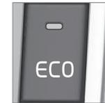
Lorsque la fonction ECO est désactivée, le symbole **ECO** sur le combiné d'instruments et le témoin du bouton ECO sont éteints. La fonction est alors désactivée jusqu'à ce que vous appuyiez à nouveau sur le bouton ECO.
