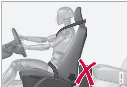
Ne placez jamais d'objets sur le plancher derrière les sièges conducteur et passager qui pourraient gêner le fonctionnement du système WHIPS.
