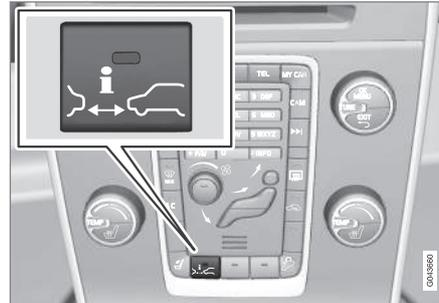
Appuyez sur le bouton de la console centrale pour activer ou désactiver la fonction. Une diode allumée sur le bouton indique que la fonction est activée.
