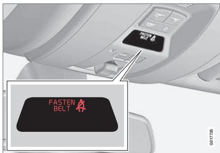
Le rappel sonore dépend de la vitesse et parfois du temps. Le rappel lumineux est situé dans la console du plafond et dans le combiné d'instruments (p. 62).
