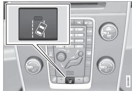
Le LDW est activé et désactivé par une touche située sur la console centrale. Une diode sur le bouton s'allume lorsque la fonction est activée.
