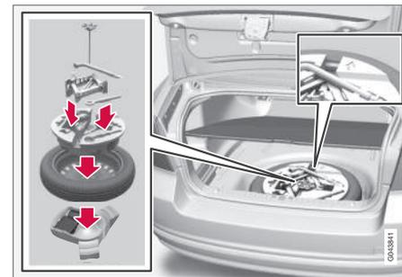
Sous le plancher du coffre à bagages se trouve l'œillet de remorquage, le cric\* et la clé à boulon de roue\*. Il y a également la place pour la douille des boulons de roue de blocage.
