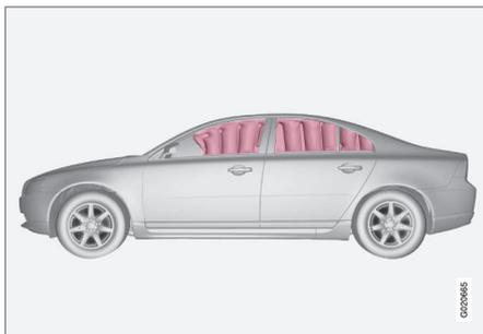
Le rideau gonflable IC (Inflatable Curtain) est un composant du système SIPS (p. 35) et du système de coussins gonflables (p. 31). Le rideau gonflable est dissimulé dans la garniture de plafond des deux côtés de la voiture et il protège les occupants des places extérieures. Lors d'une forte collision, les capteurs réagissent et le rideau gonflable se gonfle.
