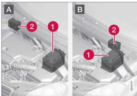
A : voiture à conduite à gauche. B : voiture à conduite à droite. (1) Batterie de démarrage<sup>19</sup> (2) Batterie d'appoint.
