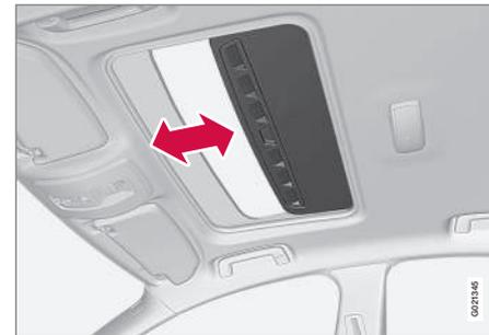
Une pression longue sur le bouton de verrouillage permet de fermer le toit ouvrant et toutes les vitres, référez-vous à Télécommande - fonctions (p. 167) et Verrouillage/déverrouillage - de l'intérieur (p. 180). Les portes et le coffre à bagages sont verrouillés. Si vous devez interrompre la fermeture, appuyez à nouveau sur le bouton de verrouillage.
