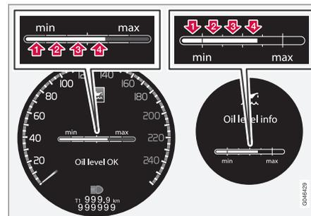
Les chiffres 1 à 4 représentent le niveau de remplissage. Ne rajoutez pas plus d'huile si le niveau de remplissage (3) ou (4) s'affiche. Le niveau de remplissage recommandé est de 4. Message et pictogramme à l'écran. L'écran gauche affiche le
