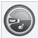
La molette permet de régler la température individuellement du côté conducteur et du côté passager.
