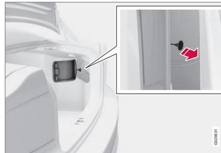
1. Ouvrez/écarterez la trappe latérale dans le compartiment à bagages (du côté de la trappe de réservoir de carburant) et cherchez un câble vert avec poignée.
