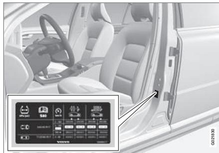
L'autocollant de pressions de pneu sur l'intérieur du montant de porte du côté conducteur (entre les portes avant et arrière) quelle pression les pneus doivent avoir à différentes conditions de charge et de vitesse. La pression correcte est aussi indiquée dans le tableau de pressions de pneu, référez-vous à Pneus - Pressions de pneus admises (p. 427).
