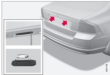
1. Desserrez les vis avec un tournevis.
