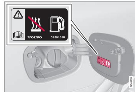
Avec des températures extérieures élevées, il peut se former une certaine surpression dans le réservoir. Ouvrez alors le bouchon lentement.
