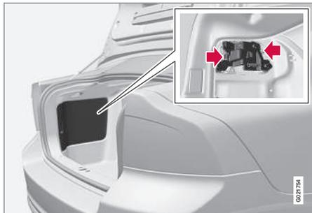
Les ampoules du combiné arrière se remplacent depuis le compartiment à bagages (pas les ampoules DEL).
