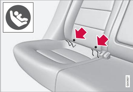
Les points de fixations du système ISOFIX sont dissimulés dans la partie inférieure du dossier de la banquette arrière, aux places extérieures.
