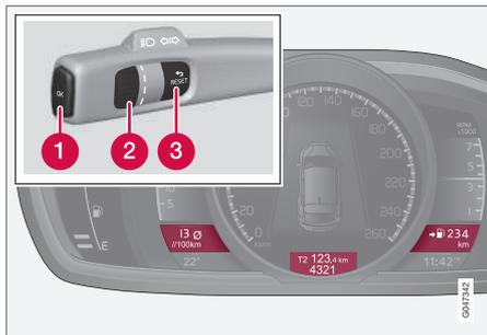
Il est possible d'afficher simultanément trois sections de l'ordinateur de bord : une dans chaque "fenêtre".
