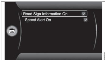
L'affichage des panneaux de limitation de vitesse sur le combiné d'instruments peut être désactivé. La fonction peut être activée/désactivée dans le système de menu **MY CAR**. Pour une description du système de menu, voir MY CAR (p. 113).
