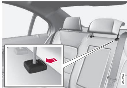
L'appuie-tête doit être réglé en hauteur selon la taille du passager. La partie centrale de l'arrière de la tête doit être au niveau du bord
