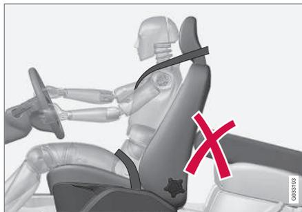
Ne placez jamais d'objets sur la banquette arrière qui pourraient gêner le fonctionnement du système WHIPS.
