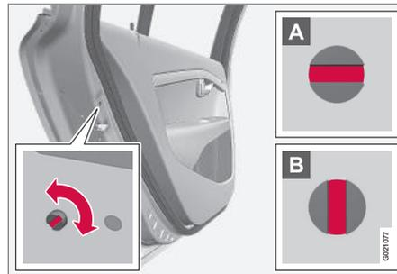
Les commandes du dispositif de sécurité enfant se situent sur le bord arrière des portes arrière et ne sont accessibles qu'après ouverture de la porte.
