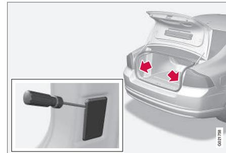
1. Délogez le bloc optique en y insérant un tournevis et en forçant légèrement sur celui-ci.
