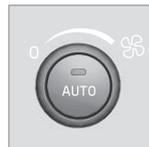
Tournez la molette pour augmenter ou réduire la vitesse du ventilateur. Si **AUTO** est sélectionné, la vitesse du ventilateur est réglée automatiquement (p. 137) - le réglage de la vitesse du ventilateur est annulé.
