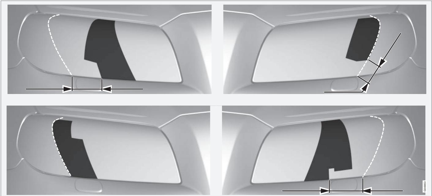
Ligne supérieure : voiture avec conduite à gauche, modèles A et B. Ligne inférieure : voiture avec conduite à droite, modèles C et D.
