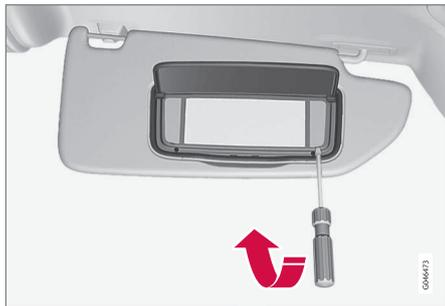
1. Insérez un tournevis sous la lentille et faites levier avec précaution sur les pattes, sur le bord.
