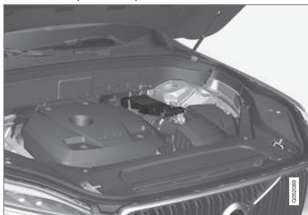
12V pomocná baterie se nachází v pouzdru u věže vzpěry.
