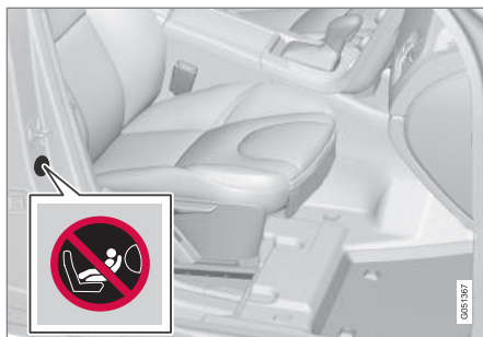
Opzione 2: Etichetta dell'airbag sul montante della portiera lato passeggero. L'etichetta è visibile quando si apre la portiera del passeggero.
