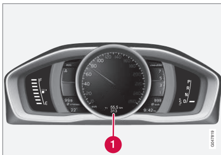
Contachilometri parziale, strumentazione digitale.
