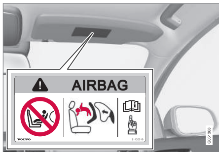
Opzione 1: Etichetta dell'airbag sull'aletta parasole lato passeggero.
