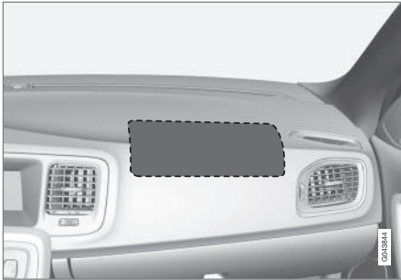
Position des Beifahrerairbags in Linkslenkern.
