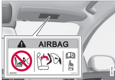
Möglichkeit 1: Airbagaufkleber an der Sonnenblende auf Beifahrerseite.
